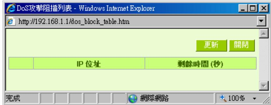
顯示被 DOS 防禦功能所阻擋的 IP 位址，以及該 IP 位址還剩餘多少時間解除阻擋
