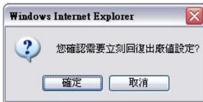
我們建議在做版本升級前請先將路由器現在的設定值存在電腦，等做完版本升級後，使用此功能將機器做出廠值設定以確保機器升級後的穩定性，然後再將剛才存在電腦的設定值存回路由器(如何儲存路由器的設定資料及升級完成後如何存回路由器，請參考 12.3 系統設定參數儲存說明)。
