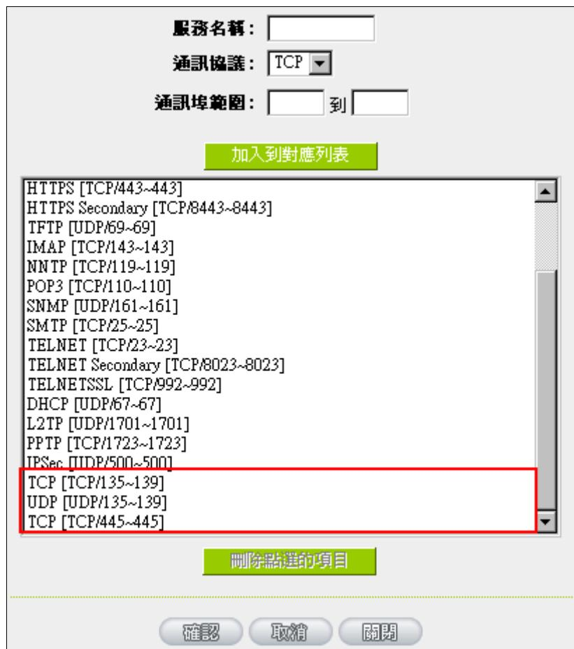
b.用防火牆裏面的“存取規則”功能將設定好的此三組埠封鎖:
