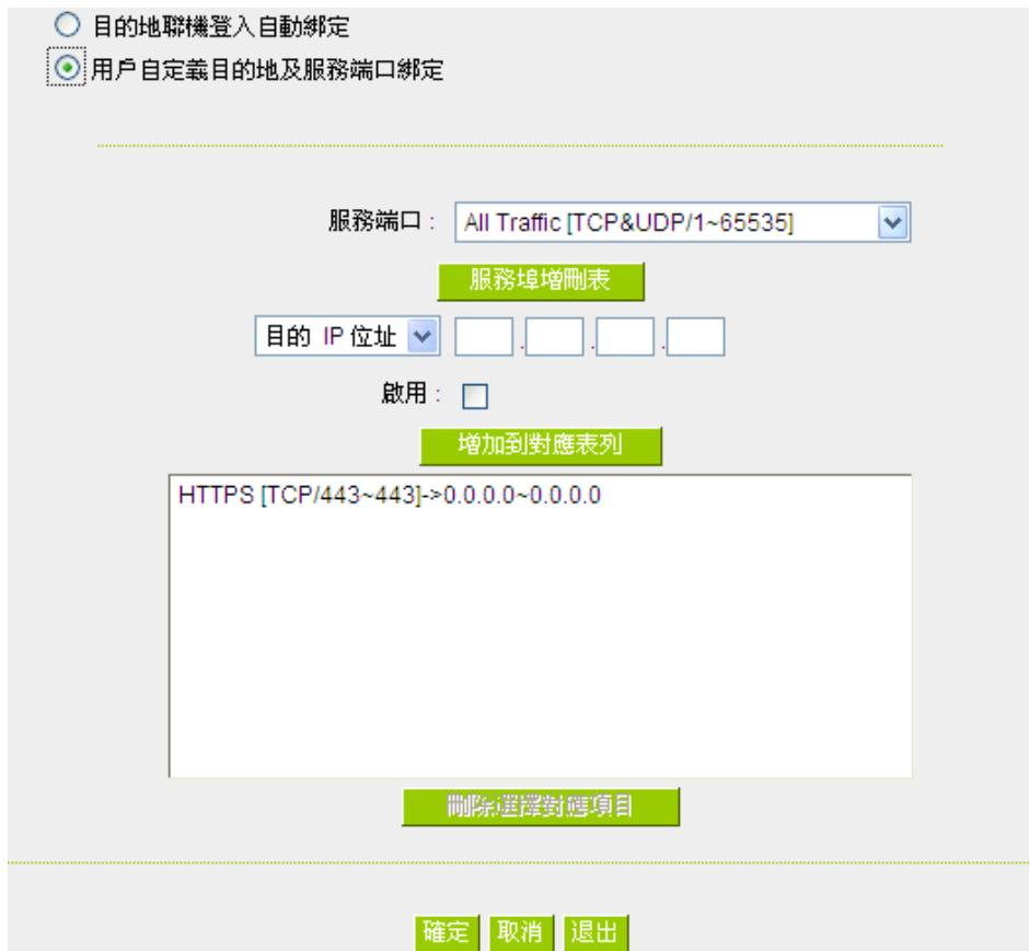
表示內網任何單一 IP，在以 TCP 443 Port 與任何目的地 (0.0.0.0 到 0 表示任何目的地) 進行連線時，都固定以同一個 WAN IP 進行連線，至於各個內網 IP 的選擇是固定在那一個 WAN IP，則是以第一次被原本連線數平衡機制所隨機分配到的 WAN IP 為準，舉例來說兩個內網 IP 192.168.100.1 與 192.168.100.2，當個別第一次進行 TCP 443 Port 連線時，192.168.100.1 被隨機平均分配到以 WAN 1 IP 連線，192.168.100.2 被隨機分配到以 WAN2 IP 連線，則只要之後 192.168.100.1 有任何 TCP 443 Port 的連線，就會固定以 WAN 1 IP 連線；192.168.100.2 有任何 TCP 443 Port 的連線，就會固定以 WAN 2 IP 連線。
