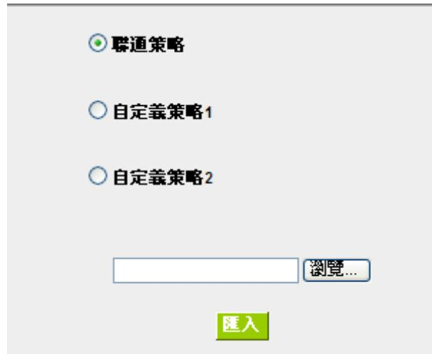
策略檔的建立可以用純文本編輯軟體來撰寫，例如使用 Windows 系統內建的“記事本”來建立。將您要指定的目的 IP 位址按照下圖的格式寫入，例如您要指定的目的 IP 位址範圍是從 140.115.1.1 到 140.115.1.255，則在“記事本”中輸入 140.115.1.1~140.115.1.255。下一個目的 IP 位址範圍則要換行輸入。請注意！若是只有一個目的 IP 位址，也需要以同樣的格式來書寫。例如指定的目的 IP 位址是 210.66.161.54，則必須寫成 210.66.161.54~210.66.161.54 格式。儲存檔後(副檔名應該是.txt)即可匯入自定策略的更新網段。
