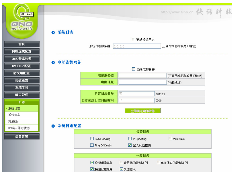
图：GQF1100 可提供系统日志、系统状态、流量统计及 IP/端口自订统计不同功能，以了解网络运作。
