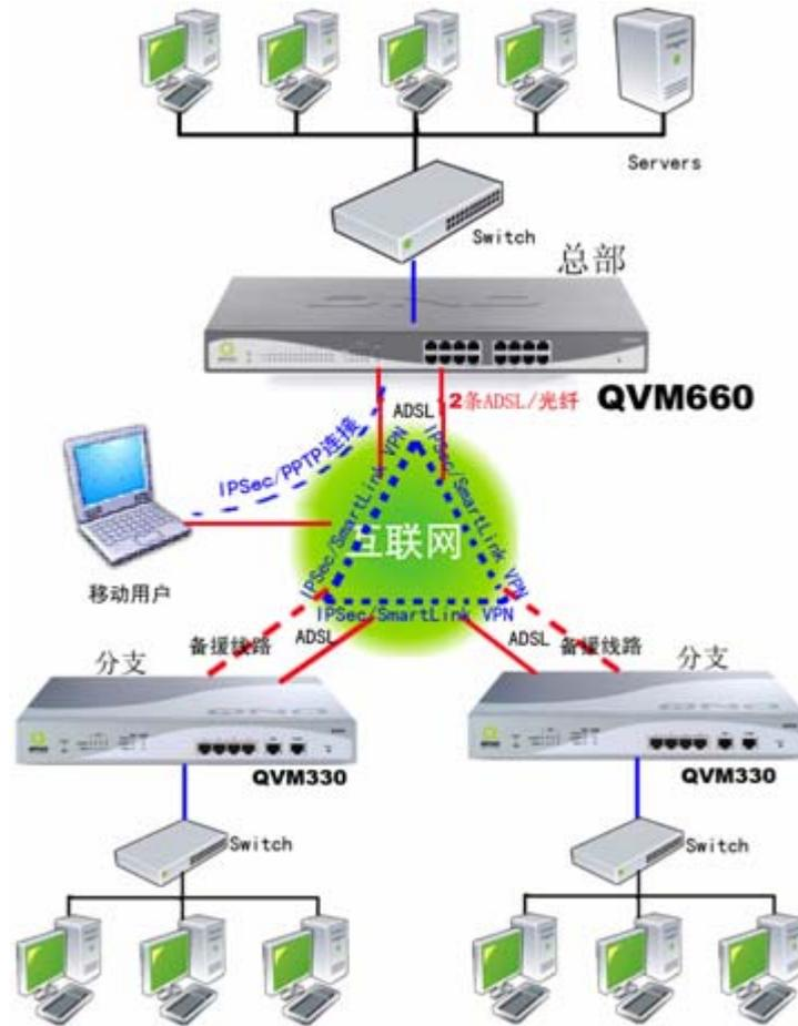
图：QVM660 以及分支 QVM330 通过 ADSL/光纤连接互联网，建立 IPsec/SmartLink 通道 VPN 连接，移动用户通过 IPsec/PPTP 连接公司网络，通过相关设置达到远程连接的目的。
