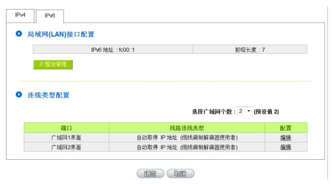
点选对应广域网字段右侧的编辑,开始设定广域网的 IPv6 网络。广域网的 IPv6 网络支持以下几种类型:
