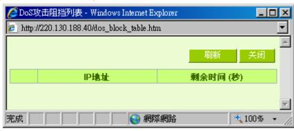
显示被 DoS 防御功能所阻挡的 IP 地址,以及该 IP 地址还剩余多少时间解除阻挡
