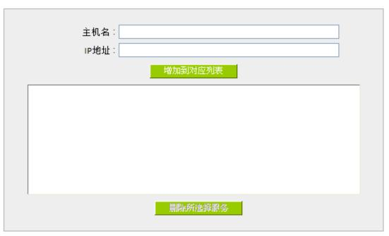
※请注意:使用 DNS Local Database 功能时需要将 DHCP 服务器的 DNS 网络服务设定为路由器的 IP 地址。设定方式请参考第 62 页的内容。
