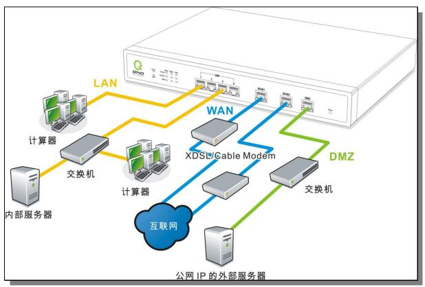
广域网络联机:连接 xDSL Modem 或光纤盒来连通互联网。或是连接交换机或外部路由器、防火墙来连通您现有的网络。
