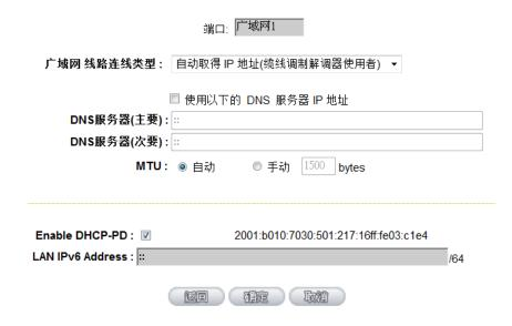
ISP 使用 DHCP 的方式派发 IPv6 地址,您可以选择手动设定 DNS 服务器地址,或是使用 ISP 派发过来的 DNS 服务器地址。
