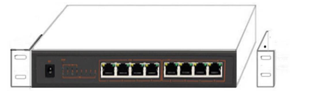
步骤二：把固定好支架的交换机和机柜，对准机架对应的螺丝孔位，然后用螺丝固定紧。
